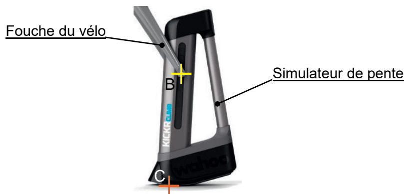
Figure 16 : simulateur de pente isolé.
